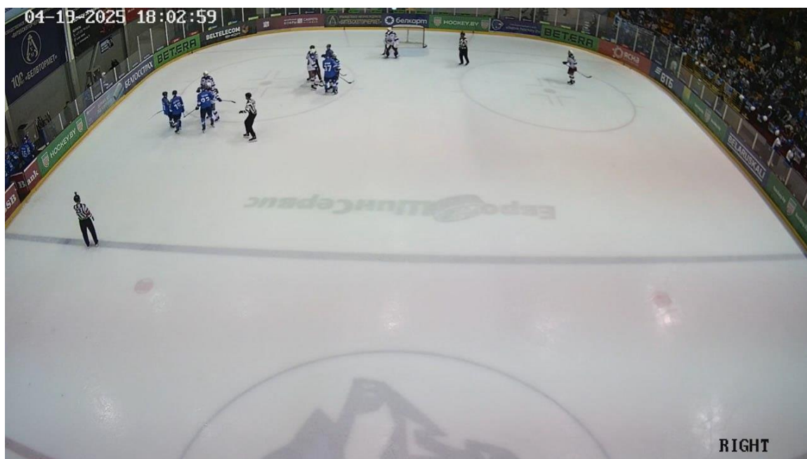
Рис.10. Изображение с камеры в конечной зоне – неправильное расположение (не захватывает синие линии на бортах)
